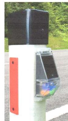
Die Wirkung unserer Geräte setzt bereits sehr früh ab dem Beginn der Dämmerung ein. Über spezielle Sensoren wird das Scheinwerferlicht von näherkommenden Fahrzeugen bereits ab einer Entfernung von mehreren 100 Metern erkannt und der optisch-/akustische Effekt danach zuverlässig ausgelöst. Sobald das Fahrzeug beim Gerät vorbeigefahren ist, wird der Effekt abgeschaltet und das Gerät wartet auf das nächste Auto. Die Lieferung erfolgt inkl. Kreuzschrauben aus Edelstahl.
